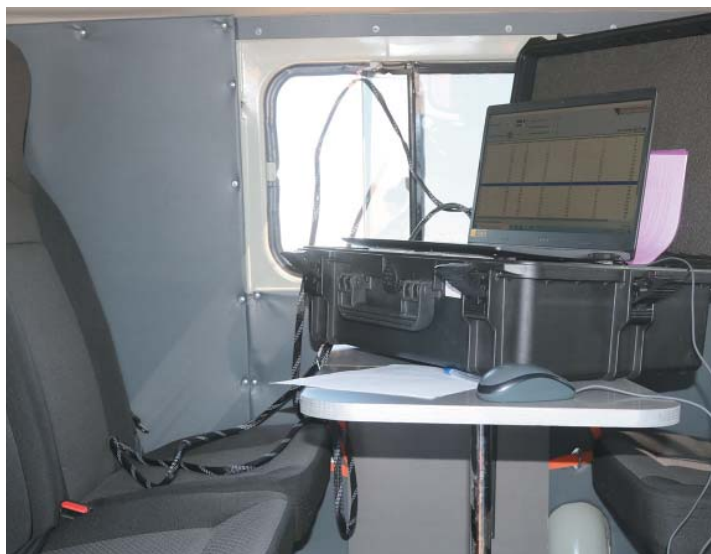
Наземная станция управления, оснащённая радиомодемом и программным обеспечением для создания полётного задания и контроля его параметров
