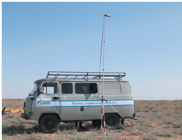
Пункт управления беспилотным летательным аппаратом на базе автомобиля «УАЗ», оснащённый инвертером, навигационным оборудованием и специальным инструментом
