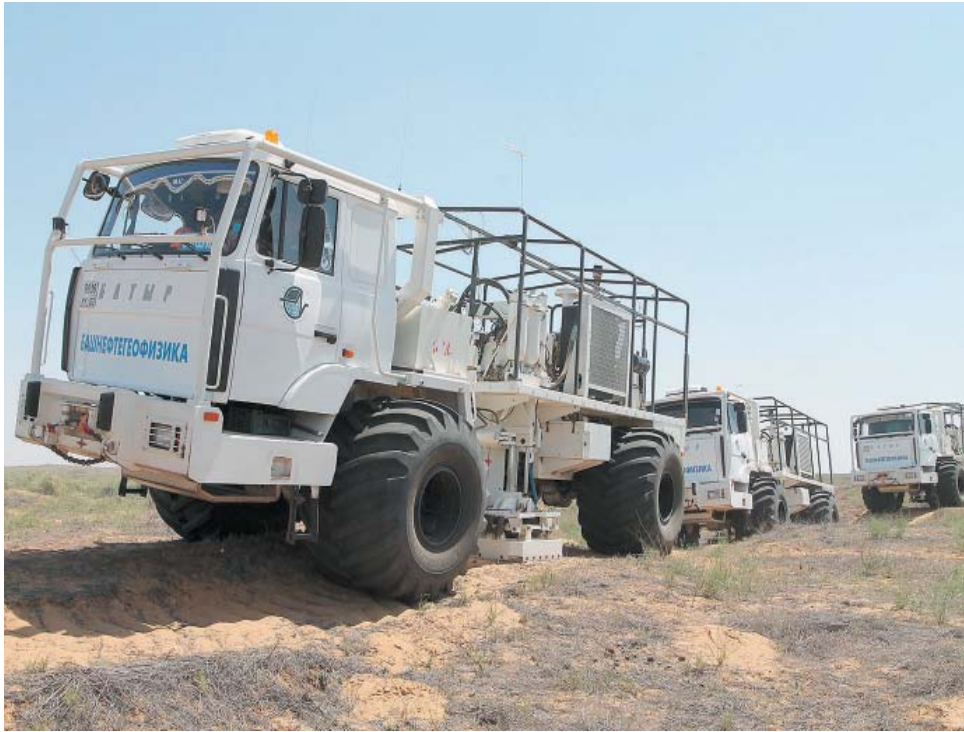
Колонна сейсмовибраторов «Батыр» на физической точке наблюдений
