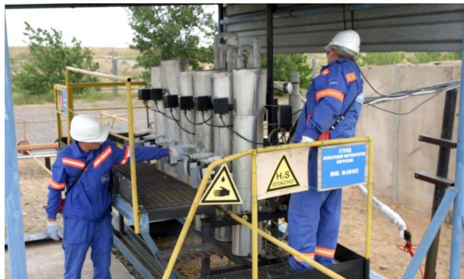
Испытание ингибиторов коррозии на стенде
