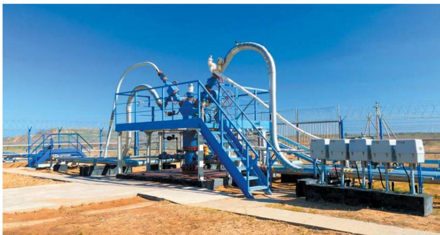
А поскольку фонтанная арматура удерживает на весу колонны НКТ, герметизирует и изолирует затрубные пространства, обеспечивает возможности регулирования режима работы скважины и её исследования, то она является одним из ключевых элементов промыслового оборудования.
