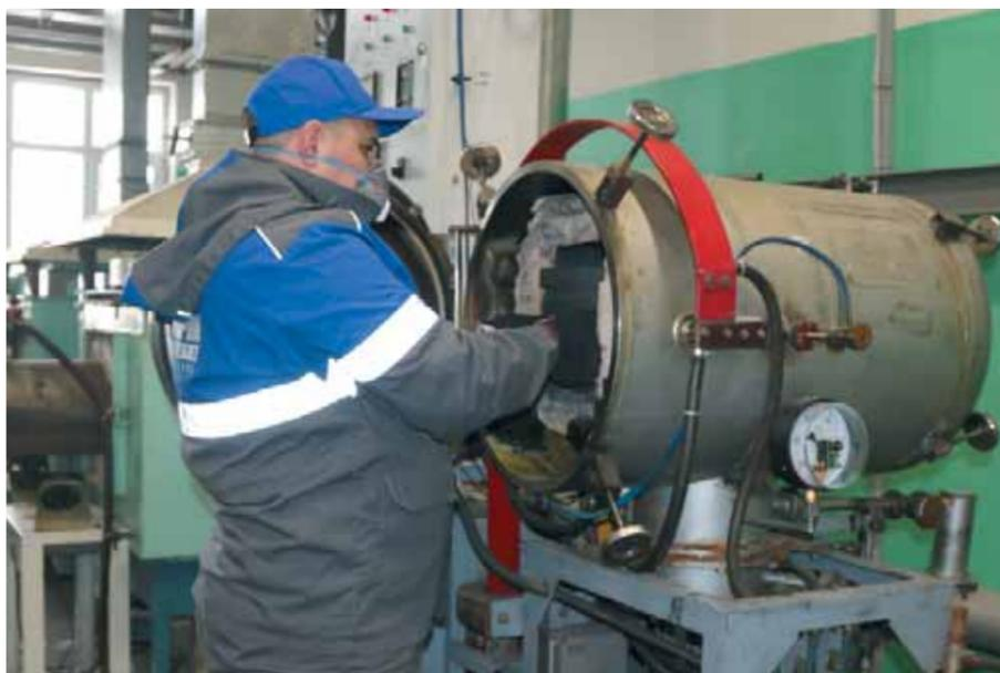
Загрузка заготовки в печь для выжигания пластификатора
