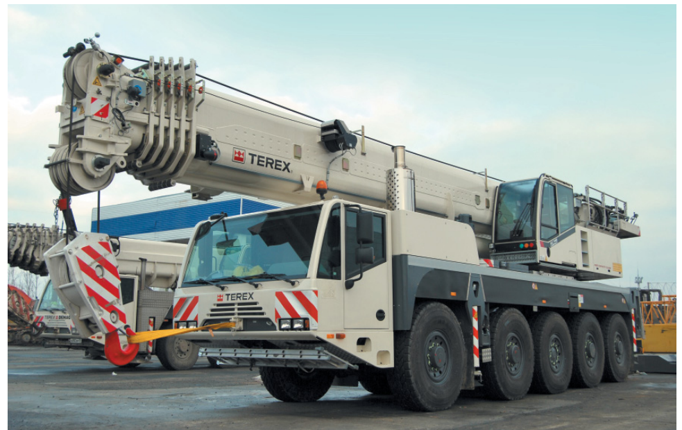
140-тонный кран немецкого производства DEMAG-TEREX AC-140 с вылетом стрелы в 60 метров
