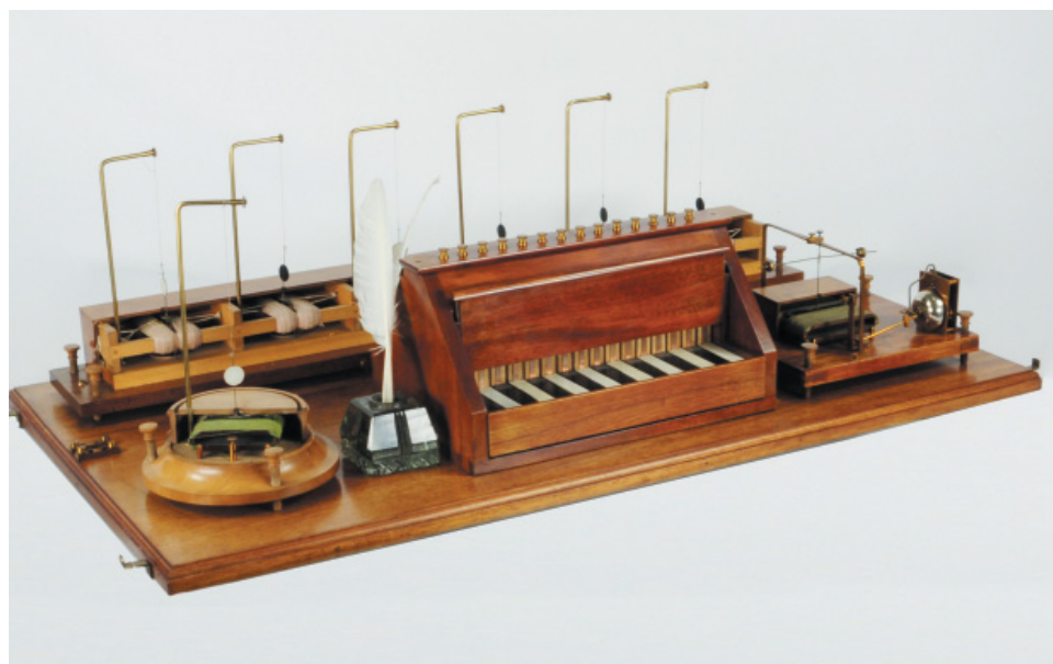
21 октября 1832 г. Шиллинг испытал в Петербурге созданный при помощи механика Ильи Алексеевича Швейкина первый в истории прибор – электромагнитный телеграф
