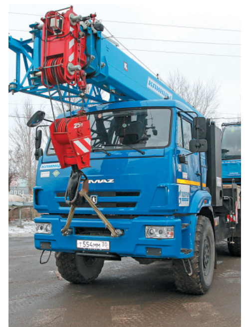
Рабочая лошадка – автокран КС-55713-1К-1 на шасси КамАЗ 43118-32 грузоподъёмностью 25 тонн
