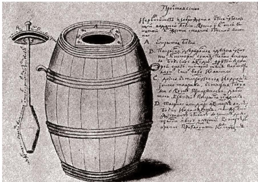
Бочка Захарии Грейла – прототип огнетушителя
