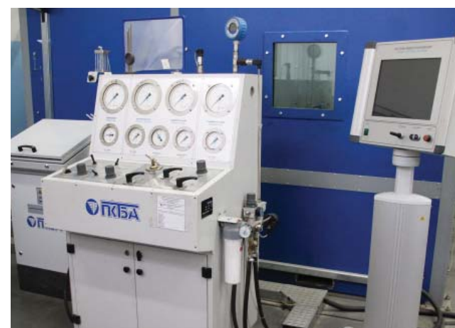
Комплекс для испытания и настройки предохранительных клапанов
