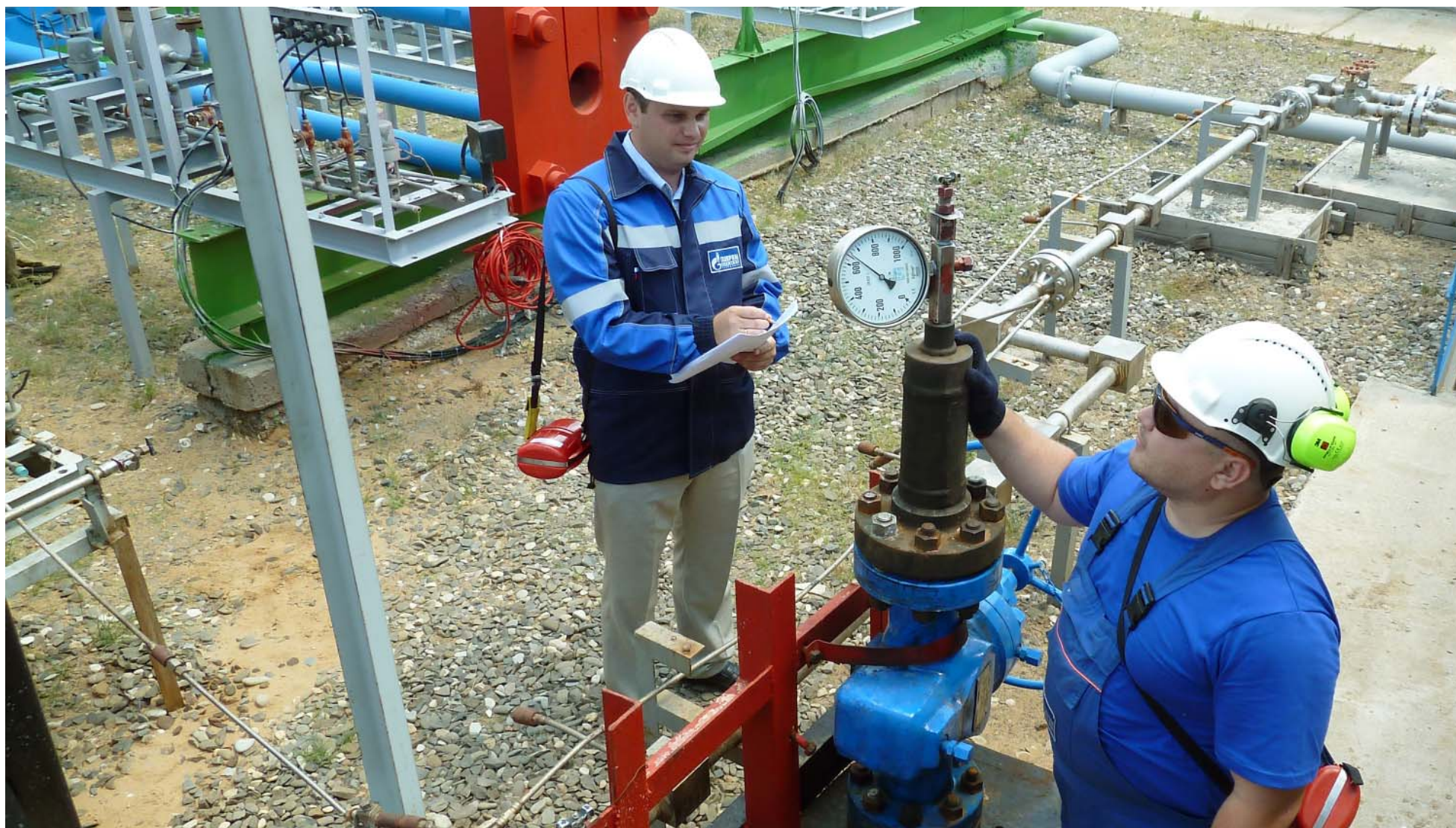
На фото (слева направо): начальник Научно-исследовательской лаборатории новой техники ЦНИПР ГПУ Дмитрий Пичугин и оператор по добыче нефти и газа Дамир Нагматулин проводят коррозионные испытания задвижки шиберной с ручным приводом производства ООО «Некст Трейд» (г. Воронеж)
