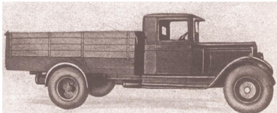
Автомашинга газобаллонной модификации ЗИС-30
