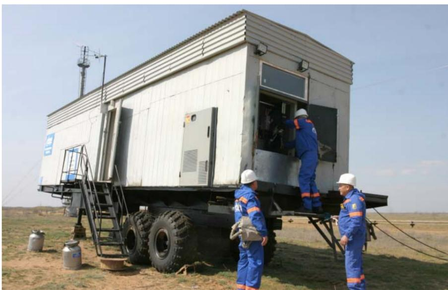
Ежедневную деятельность специалистов Цеха по работе с подземным оборудованием ГПУ невозможно представить без передвижных гидравлических лебёдок. Именно это оборудование используется во время профилактических планово-предупредительных ремонтных работ, когда подземное оборудование извлекается на поверхность тросовым инструментом, или при проведении геофизических ис-
