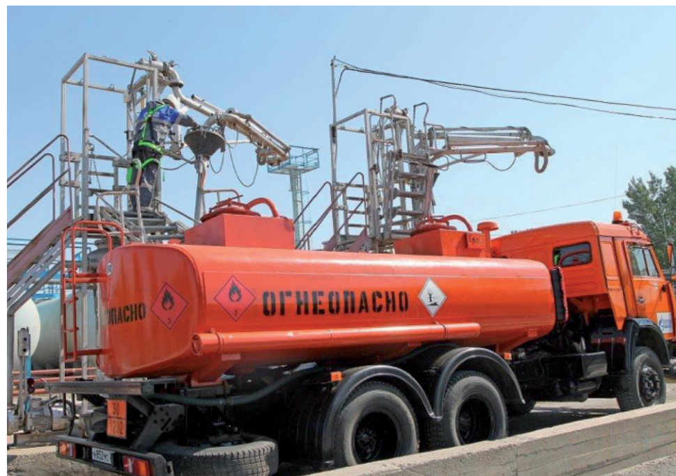
Налие ингибитора коррозии в автоцистерну
