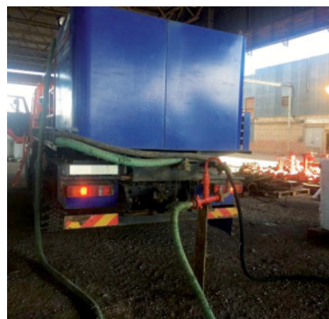
Внешний вид инжекционной установки для ввода микросфер
