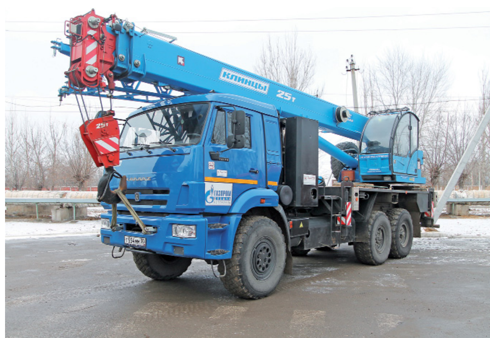
Стреловой автокран КамАЗ 43118 КС 55713 на газомоторном топливе, 2018 год
