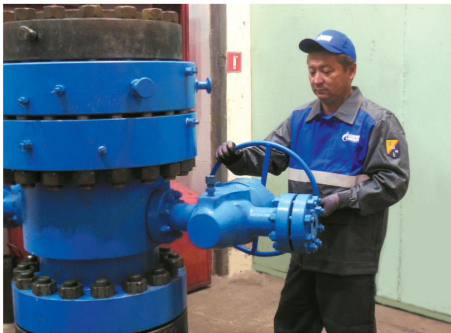
Тимур Сапдалиев проводит испытания колонной головки
