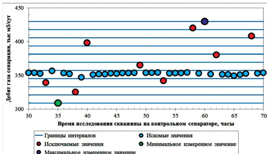
Иллюстрация работы алгоритма на примере режима работы скважины
