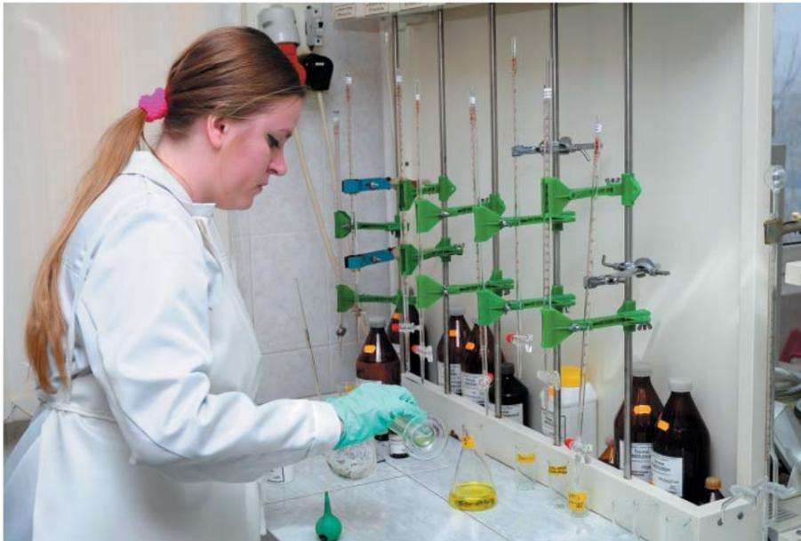
Определение хлоридов в природной поверхностной воде титриметрическим методом
