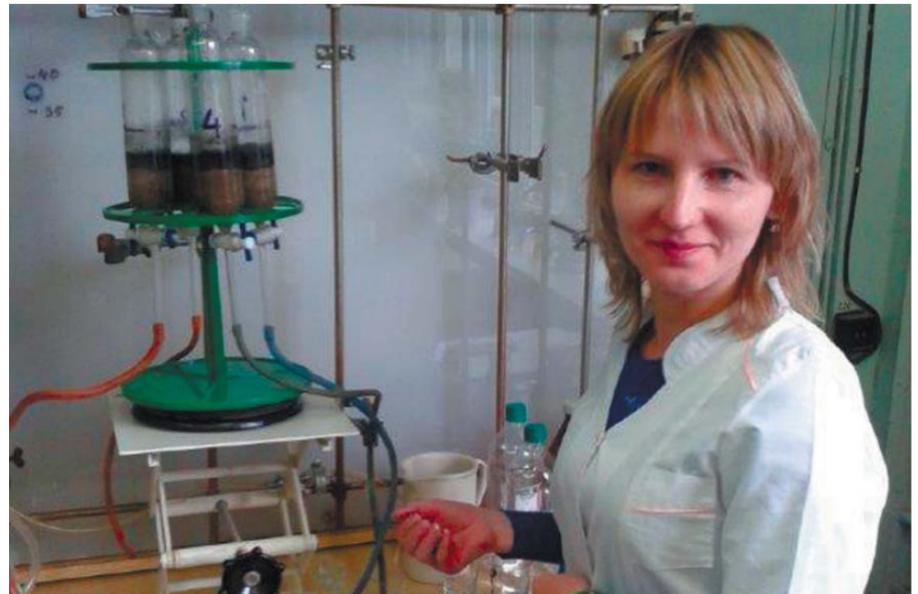
чал риск случайного контакта сотрудника с данным раствором при обработке каждого последующего образца, – поясняет молодой рационализатор. Предлагаемый вариант обеспечил быстрый и безопасный процесс удаления продуктов коррозии с поверхности образцов-свидетелей за счёт их одномоментного погружения – до пятнадцати штук – в раствор соляной кислоты с помощью приспособления, обеспечивающего надёжную фиксацию образцов в вертикальном положении.
