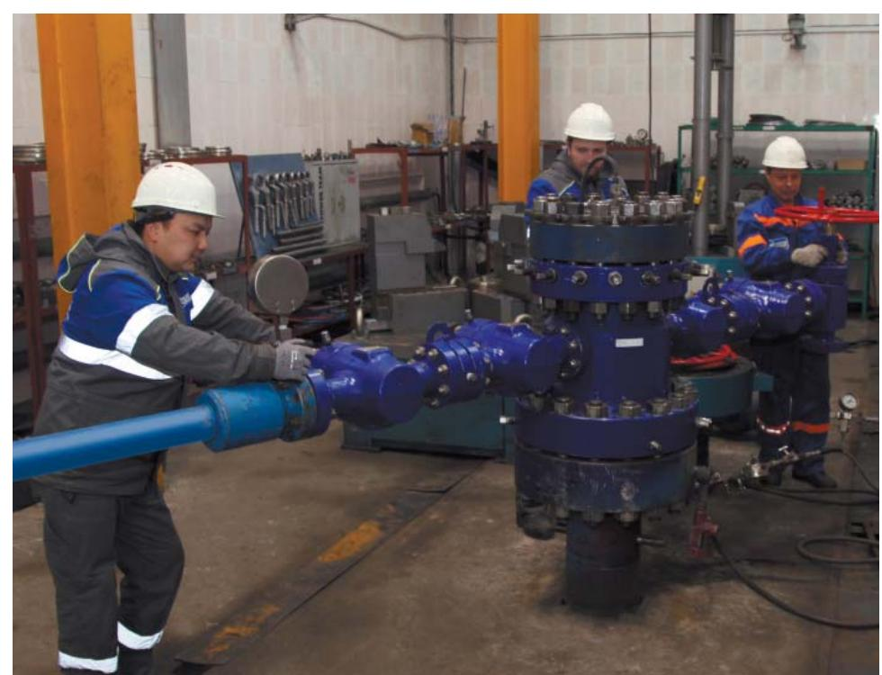
Слесари-ремонтисты (слева направо Р. Сисенов, Е. Гладун, А. Помогаев) проводят испытания на герметичность трубной головки фирмы «Корвет»
