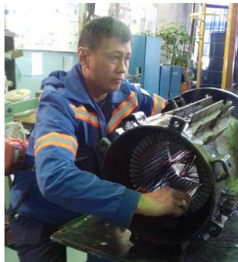
Электромонтёр по ремонту обмоток и изоляции электрооборудования 6 разряда Кайрат Мукаббетов укладывает секции обмоточного провода в статор электродвигателя
