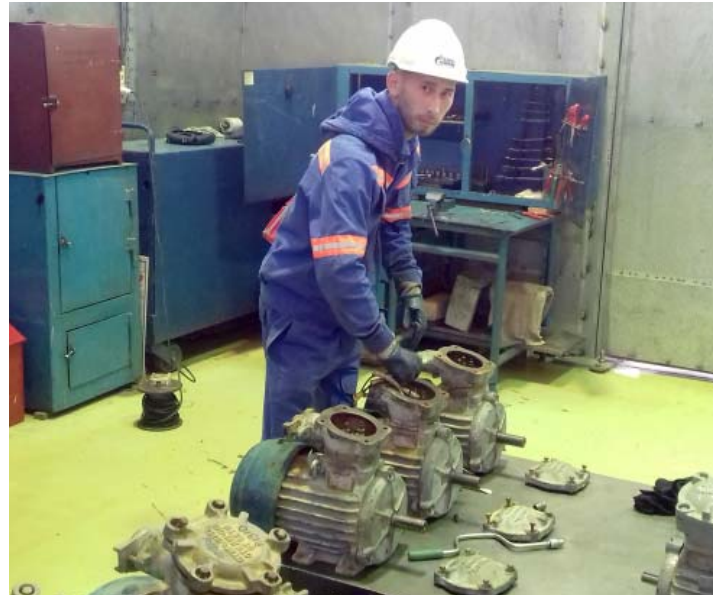
Электромонтёр по ремонту и обслуживанию электрооборудования 4 разряда Ильдар Утарситов производит подключение электродвигателя к сети напряжения для его обкатки на холостом ходу
