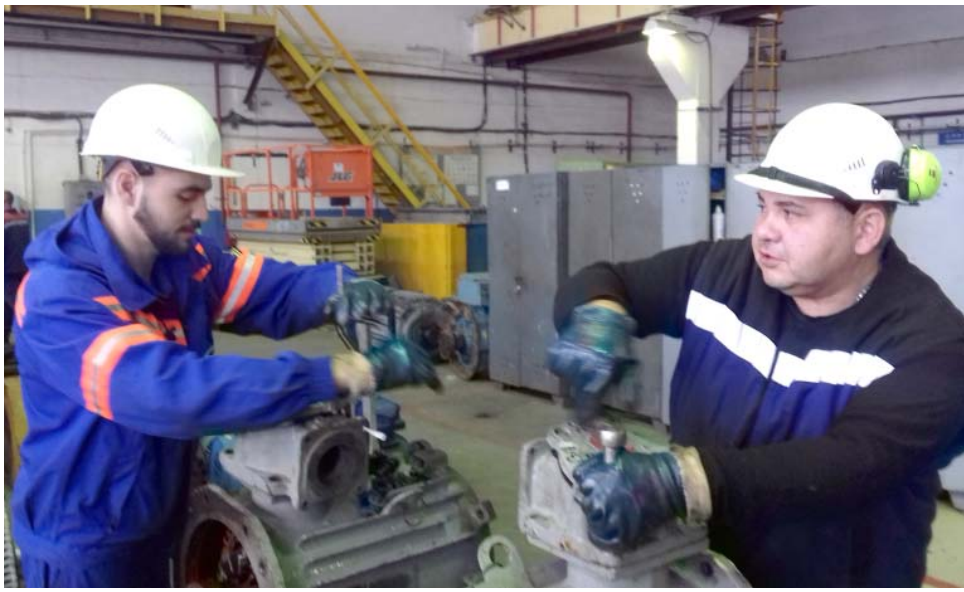
Слева направо: слесари механосборочных работ Владислав Козель и Максим Кузнецов занимаются сборкой взрывозащищённого электродвигателя мощностью 30 кВт
