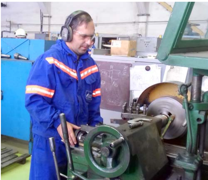
Токарь 6 разряда цеха КРЭ Андрей Абакумов занимается изготовлением проходного изолятора для электродвигателя
