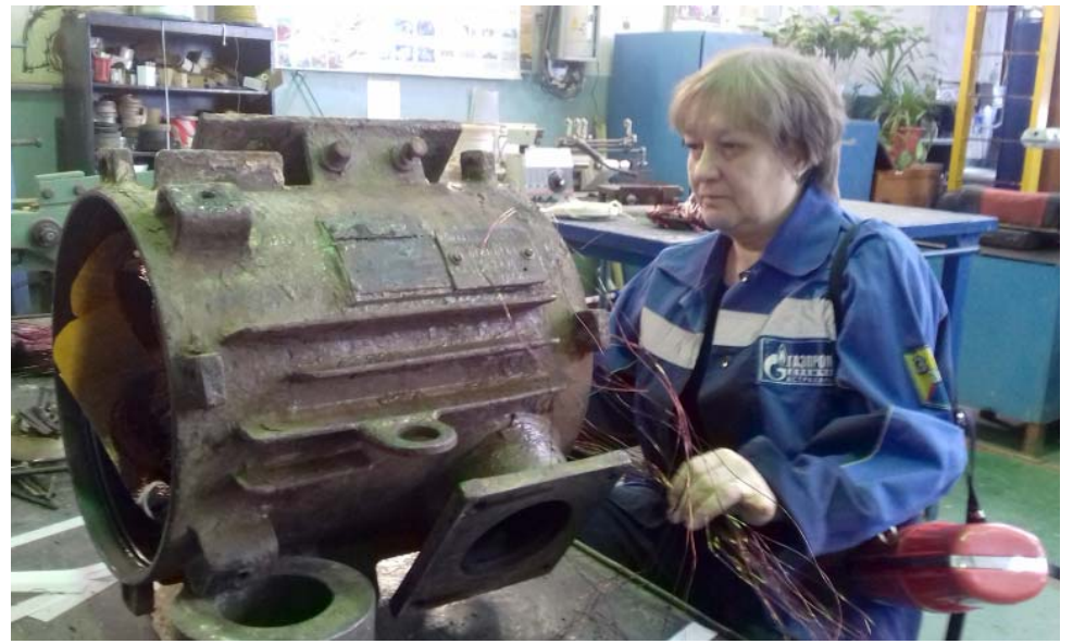
Электромонтёр по ремонту обмоток и изоляции электрооборудования цеха КРЭ Раисы Швелёвой. Бандаже «лобовой» части обмотки статора электродвигателя
