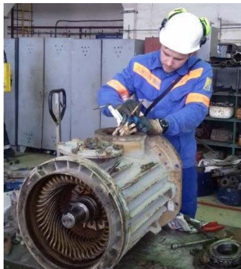
Электромонтёр по ремонту и обслуживанию электрооборудования Александр Столяр проводит замену изоляторов у взрывозащищённого электродвигателя мощностью 30 кВт
