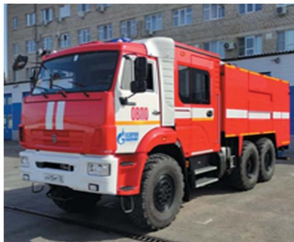
Пожарная автоцистерна на базе автомобиля «КамАЗ» АЦ-5-40/4 (43114)
