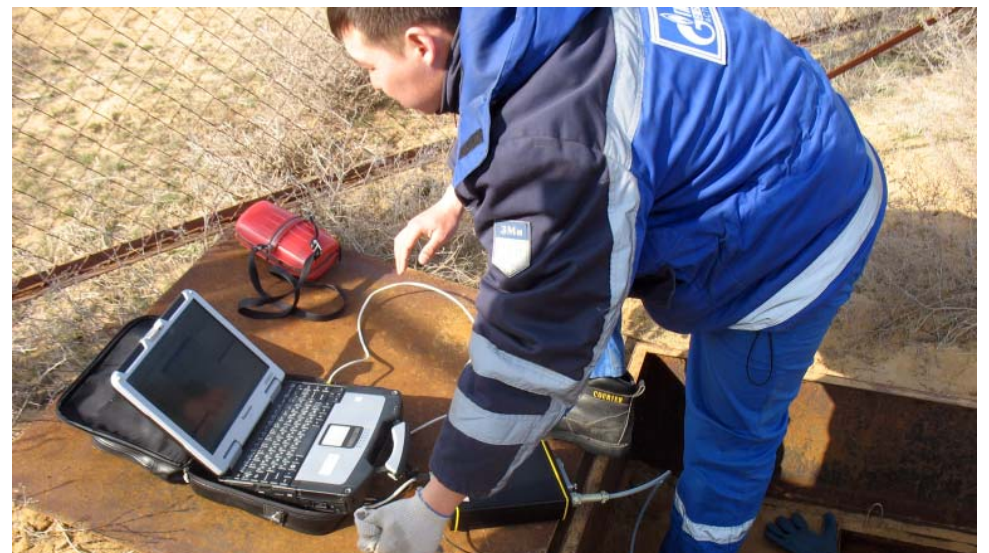
Сбор данных о сейсмособытиях с регистратора сейсмических сигналов
