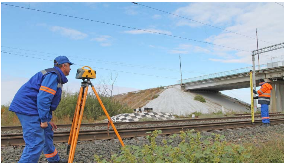
Наблюдения за деформированием путепровода
