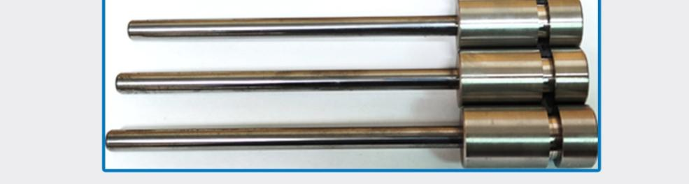
Для сред, содержащих твердые взвешенные частицы, вызывающие сильный абразивный износ рабочих частей плунжеров, приводящий к интенсивному износу уплотнения дозировочных насосов и потерю герметичности, целесообразно использовать рабочих частей плунжеров из твердосплавных материалов.
