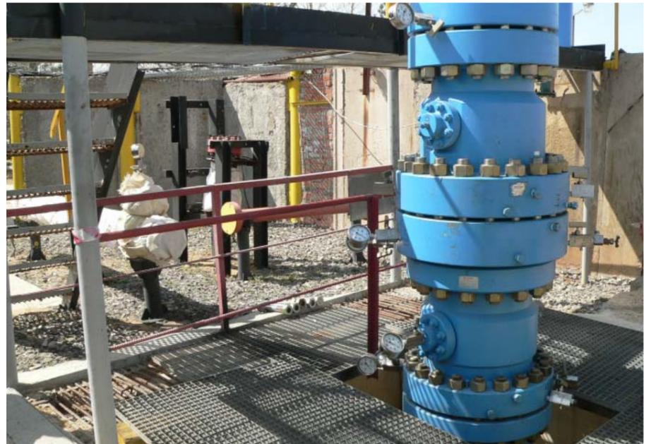
ших технологических процессов. Специалисты ЦНИПР создали стенд, на котором проводились испытания антикоррозийных свойств оборудования для работы в агрессивной среде.
