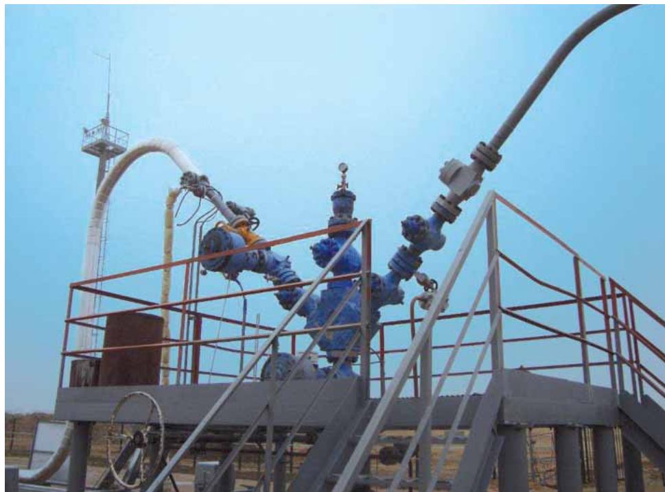
Фонтанная «ёлка», изготовленная на Воронежском механическом заводе, установлена на скважине № 619
